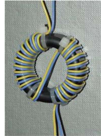
Strom-Balun mit hoher Drossel-induktivität für undefinierte Impedanzen
